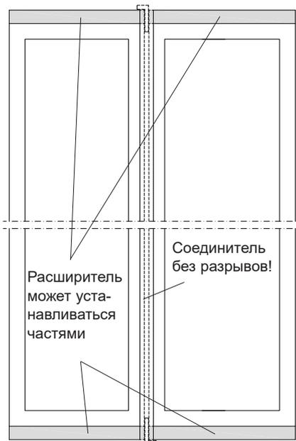
**Рис. 8 Соединительные профили всегда должны быть сплошными!**
