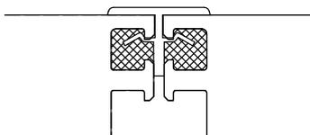
Герметизация с помощью герметика
